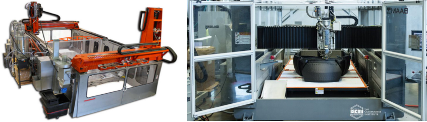
Abb. 10: Additive Fertigung und Fräszentrum LSAM [The17] (links) und BAAM [Cin15b] (rechts)
