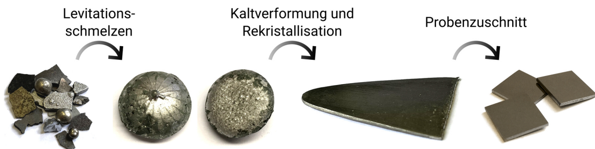
Abbildung 4: Schematische Darstellung der einzelnen Schritte zur Probenherstellung: Die mittels Levitationsschmelzen aus den reinen Materialien hergestellten Legierungen wurden durch Kaltverformung zu Blechen verarbeitet, aus denen Proben ausgeschnitten wurden.
