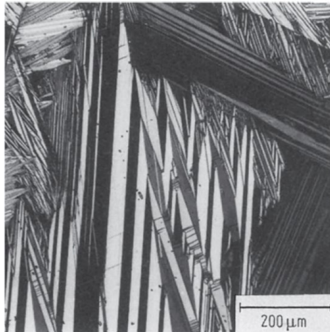
Abbildung 2.3: Martensitplatten in selbstakkommodierenden Gruppen bei einer in Wasser abgeschreckten Cu-Zn-Al Formgedächtnislegierung [30]
