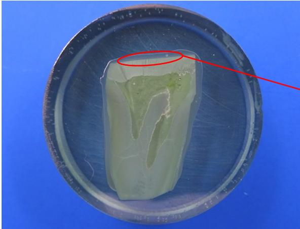
Abbildung 65: Foto der *Futurabond*-GNF-Rinderzahn-Probe, eingebettet in Epoxidharz, geschliffen und goldbedampft
