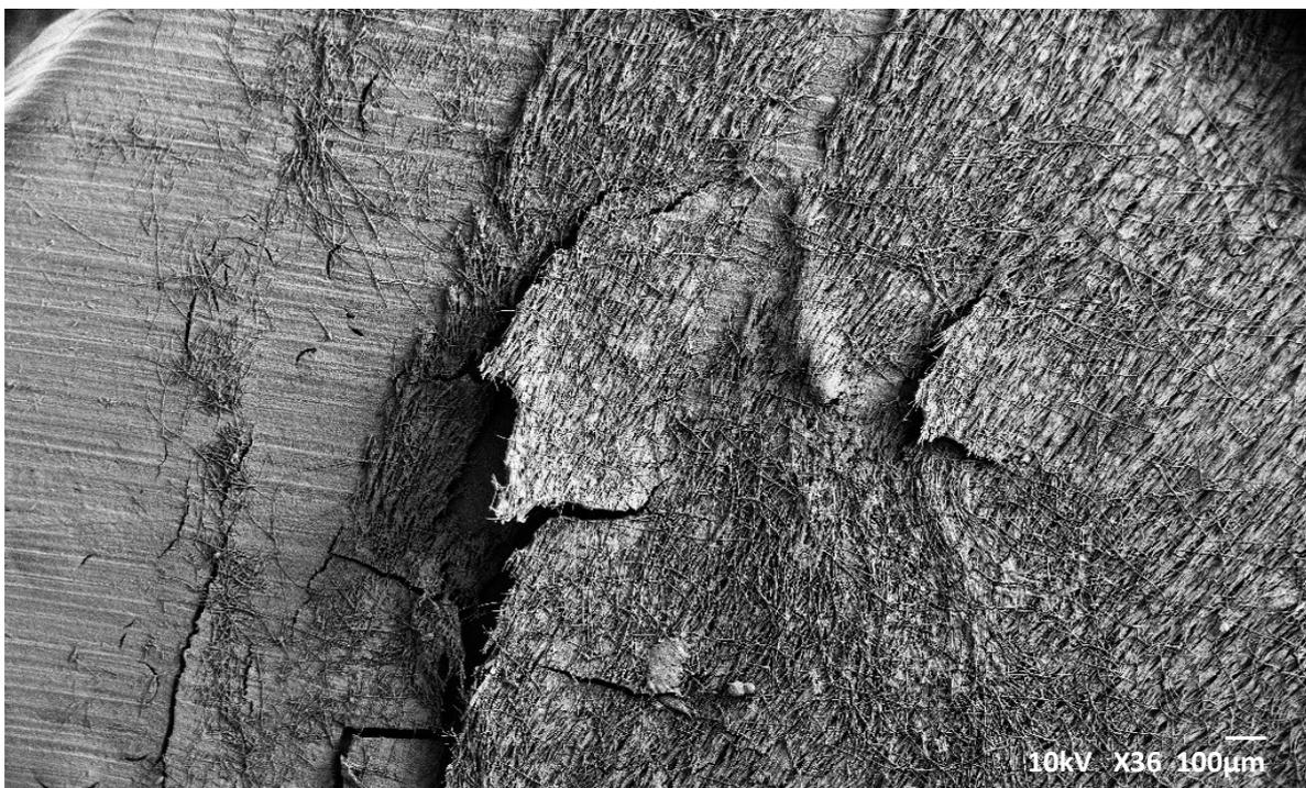
Abbildung 42: *Universal Bond* mit GNF, Risse im Adhäsiv abgelöst vom Prüfkörper
