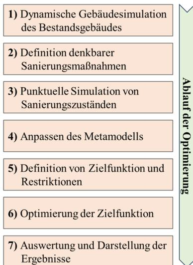
Abbildung 1: Ablaufdiagramm der entwickelten Sanierungsmethodik
