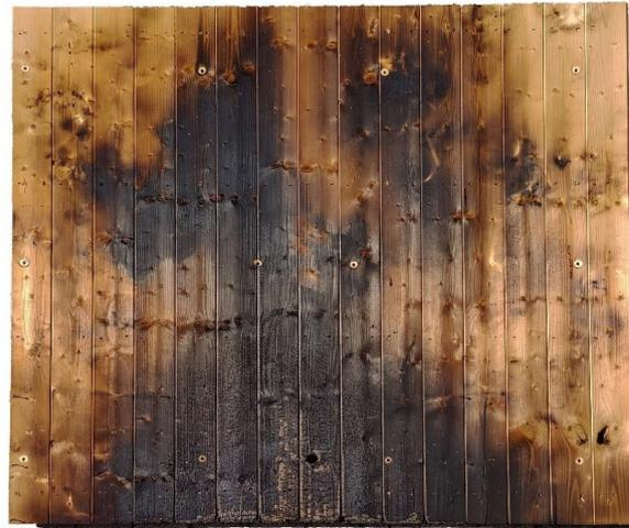
*Abbildung 6: Fotodokumentation der Holzschalung oberhalb der Brandsperre nach Beendigung des Versuches und der Beobachtungszeit für Test 3*
