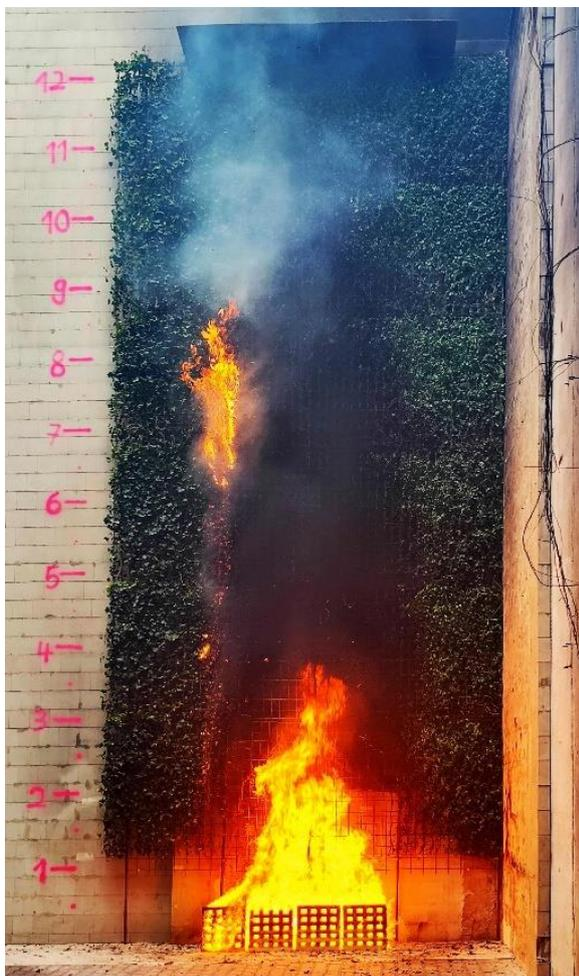
*Abbildung 7: Foto des abschließenden Großbrandversuchs V1 des Forschungsvorhabens FireSafeGreen mit der 12 m hohen flächigen Anordnung und vitalen Kletterpflanzen*
