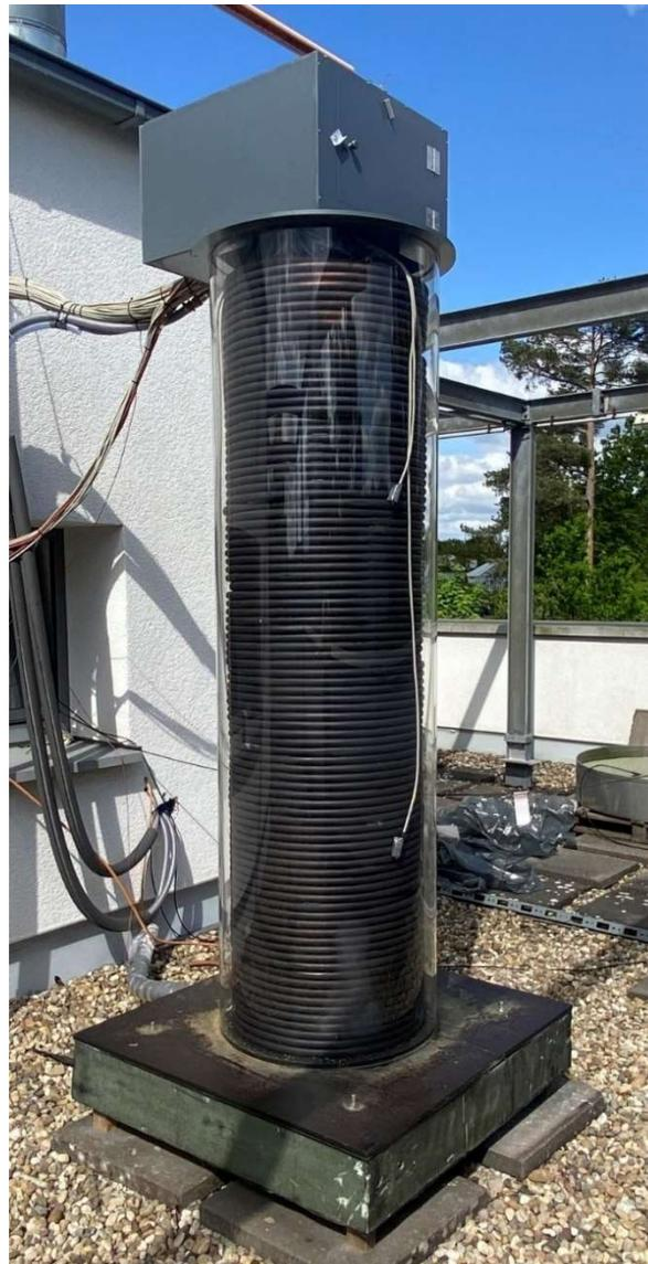
Abbildung 2: Prototyp des Energiepfahls
