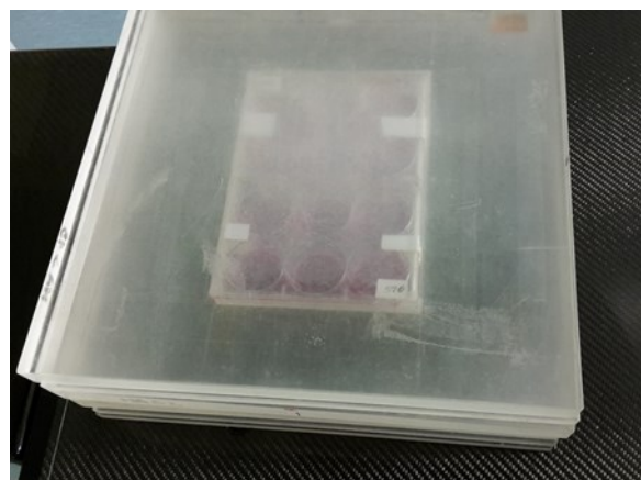
Abb. 4 Lagerung der Zellkulturen. Darstellung der Plexiglasscheiben zur Lagerung der Zellkulturen während der Bestrahlung.
