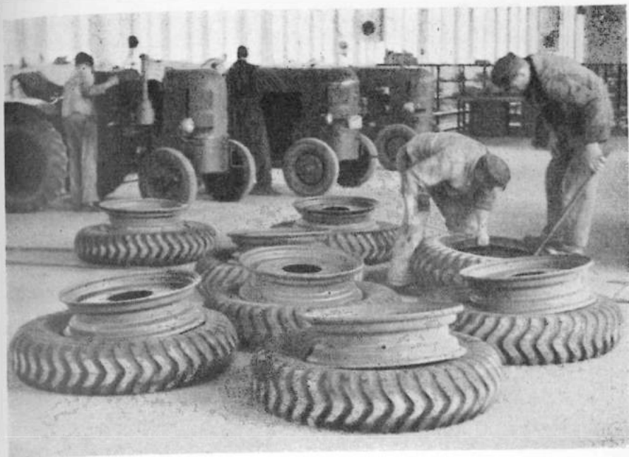
Im Ifa-Schlepperwerk : Reifenmontage
