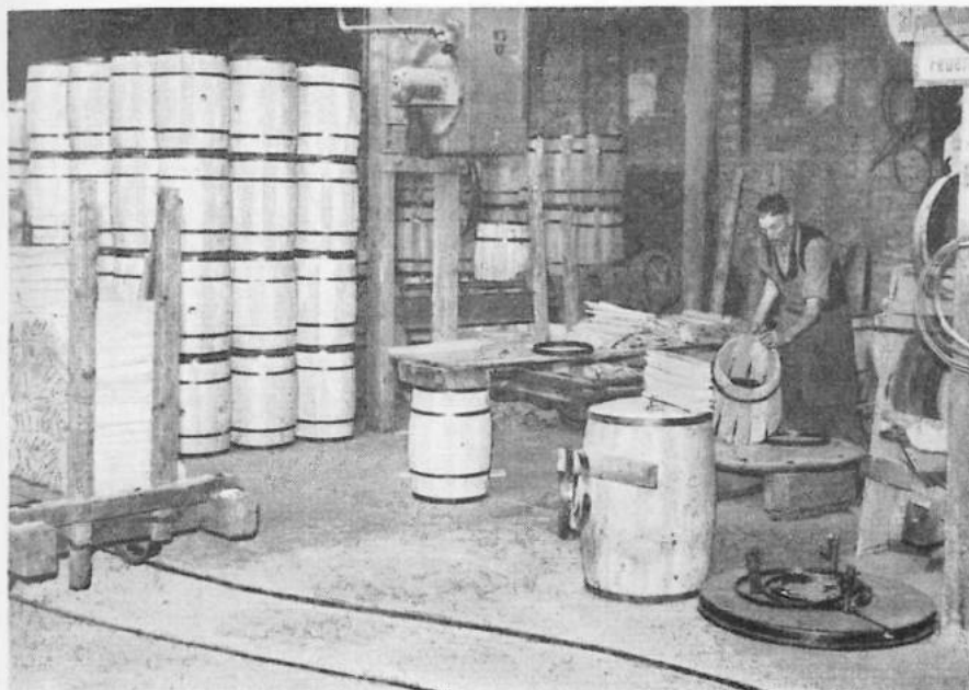
In der Faßfabrik Ilfeld: Ein Faß wird zusammengesetzt
