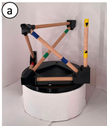
Abbildung 5: Die Abbildung zeigt das Referenzobjekt welches dem Prüfkörper der VDI/VDE 2634 Norm nachempfunden ist und die Rekonstruktion durch den 3D Scanner.
