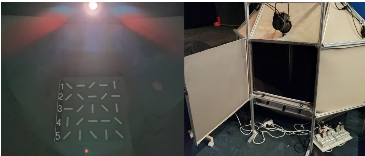
Abbildung 3: Blick auf das Testfeld bei eingeschalteter Blendquelle (rechts). Rückseite der Einblickvorrichtung mit offener Klappe zum Wechseln der Testfelder (links).
