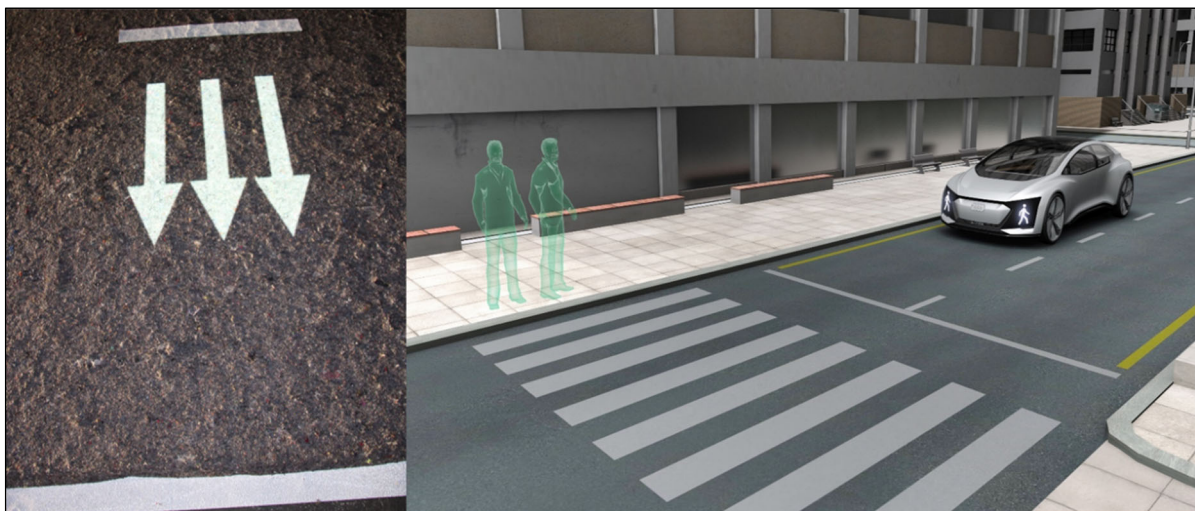
Abbildung 1 Darstellung projizierter Symbole direkt vor einem adressierten Empfänger (links) und Symbole auf der Fahrzeugfront zur Kommunikation mit anderen Verkehrsteilnehmern (rechts) [4]
