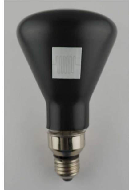
Abbildung 4: Foto einer Lichtstärkenormallampe vom Typ OSRAM WI41/G
