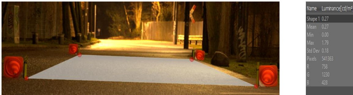
Abbildung 7: Beispielmessung und -auswertung der Leuchtdichte mittels Digitalkamera
