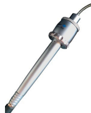
Abbildung 24: 2 cc Kuppler von Brüel & Kjær mit Adapter für IdO sowie HdO mit RIC.
