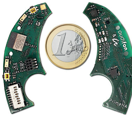
Abbildung 4.1: Gefertigte und bestückte Leiterplatte vorne und hinten mit 1 € Stück als Größenvergleich.
