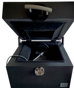
Abbildung 2.3: Messbox TBS25 von Interacoustics mit Messmikrofon und Kuppler.
