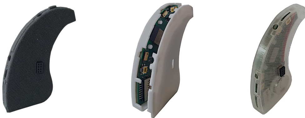
Abbildung 3.19: Platine mit Gehäuse aus gedruckten Gehäuseteilen. Gehäuse, Taster sowie microSD-Karten Abdeckung mit SLS-Verfahren gedruckt (links), mit FDM-Verfahren gedrucktes halb offenes (mittig) und geschlossenes Gehäuse (rechts).
