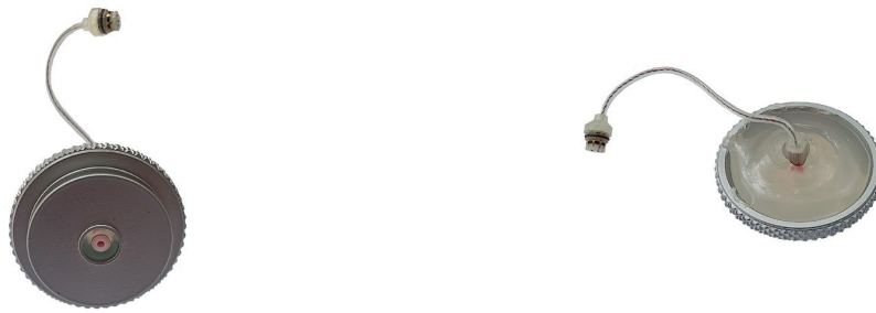
Abbildung 4.3: Nachbildung einer Spezialanfertigung von Sonion zur Kontaktierung von Hörer und Kuppler.
