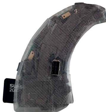
Abbildung E.3: PrimeHA mit Gehäuse und mit Schall-absorbierendem Textil gefüllt.
