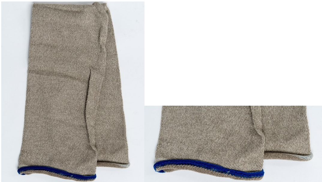
Abbildung 7 Strickschlauch aus Funktionsfasergarn blau 0145; Material: 1xNm 55/1 Lyocell/ELS 3xNm 60/1 Bw; Beschreibung: ca. 30 % Funktionsfasergarn und davon 6 % Vitamin E-Faser V2637
