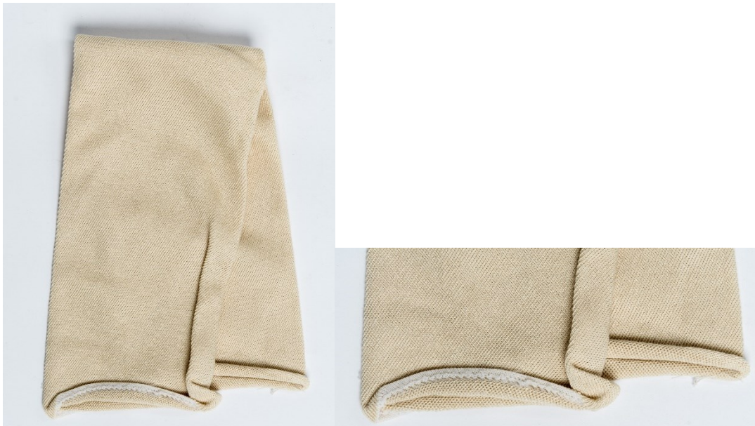
Abbildung 4 Strickschlauch aus Funktionsfasergarn weiß 0100; Material: 4xNm 55/1 Lyocell/ELS; Beschreibung: 100 % Funktionsfasergarn und davon 20 % Vitamin E-Faser V2637
