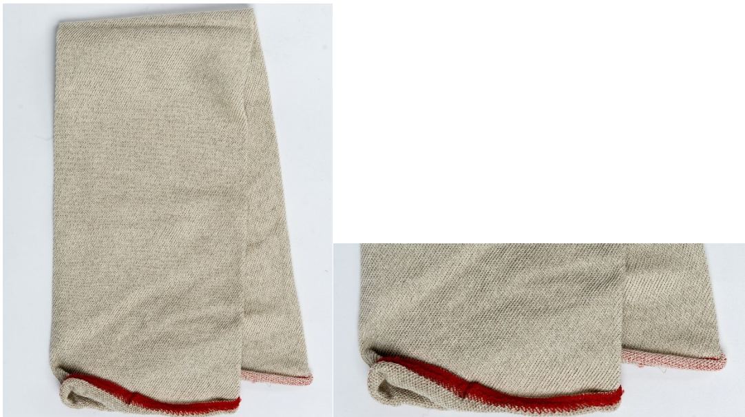
Abbildung 5 Strickschlauch aus Funktionsfasergarn rot 0173; Material: 3xNm 55/1 Lyocell/ELS 1xNm 60/1 Bw; Beschreibung: ca. 75 % Funktionsfasergarn und davon 15 % Vitamin E-Faser V2637
