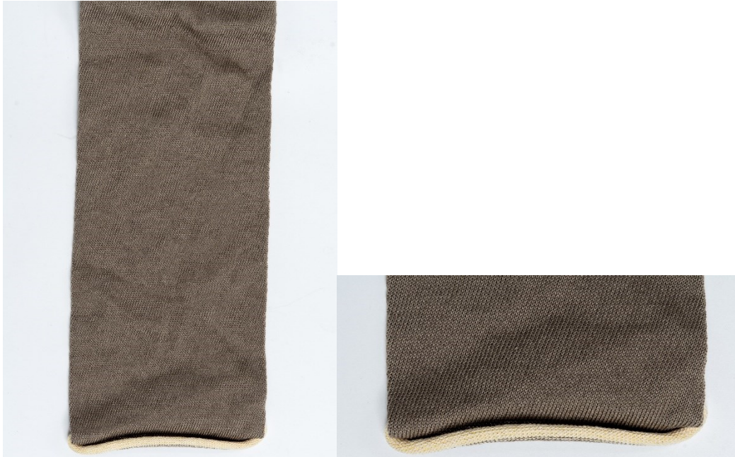
Abbildung 8 Strickschlauch aus Baumwollgarn gelb 0181; Material: 4xNm 60/1 Bw; Beschreibung: 100 % Baumwollgarn als Nullprobe
