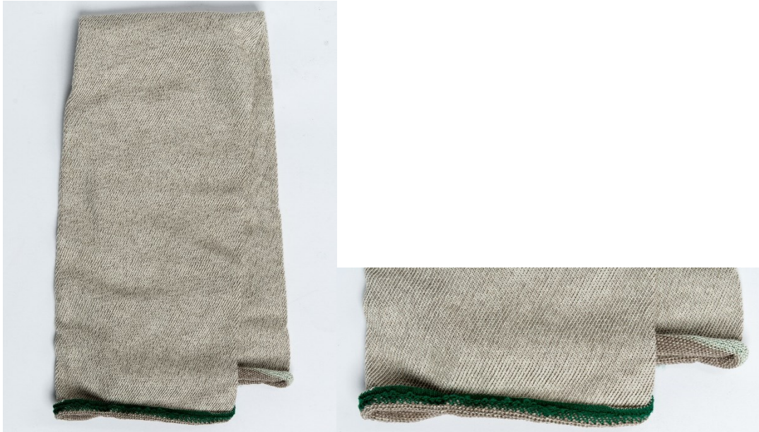
Abbildung 6 Strickschlauch aus Funktionsfasergarn grün 0168; Material: 2xNm 55/1 Lyocell/ELS 2xNm 60/1 Bw; Beschreibung: ca. 50 % Funktionsfasergarn und davon 10 % Vitamin E-Faser V2637
