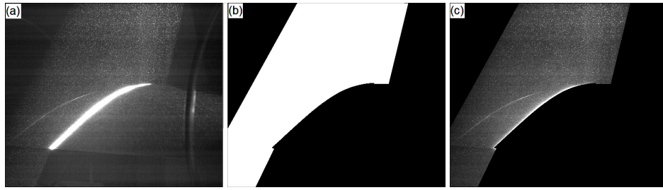
Abbildung 4.3: (a) Einzelnes Rohbild einer PIV-Aufnahme der in Strömungsrichtung linken Kamera; (b) Mittels Matlab erzeugte Maskierung; (c) Anwendung der Maskierung auf das Rohbild.
