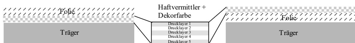
Abbildung 2.4: Grundsätzlicher Aufbau einer IML Folie mit rück- (links) und vorderseitig (rechts) bedruckten Folien
