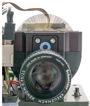
Abb. 5.4: GOBO-Projektor des Sensors mit abgenommenem Projektorgehäuse.
