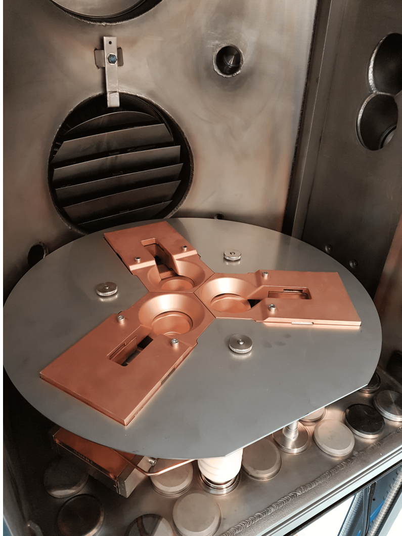
Abbildung 3.2: Drei-Quellen-Verdampfeinheit der Firma Ferrotec, eingesetzt in einen Rezipienten des Typs L560S der Firma Leybold AG. Die Tiegeleinsätze sind um 120^\circ versetzt symmetrisch um den Mittelpunkt angeordnet. Der Abstand der Tiegelmittelpunkte zur Mitte beträgt etwa 5 cm. Die jeweiligen zur Verdampfung der in die Tiegel einfüllbaren Materialien benötigten Elektronenstrahlen werden durch den gegenüber der Mitte liegenden Spalt hindurch gebeugt.
