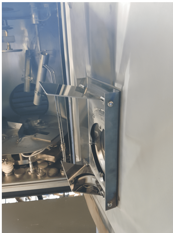
Abbildung 5.3: Entworfenes beschichtungsfestes Periskop, das die Beobachtung des Elektronenstrahlrasters während der Beschichtung ermöglicht. Es verhindert die normalerweise in kürzester Zeit auftretende Verspiegelung des Sichtfensters und richtet den Blick auf die Targetflächen. Durch die Beschichtung wird die Oberfläche der Umlenkscheiben automatisch stark verspiegelt, so dass ein hoher Bildkontrast entsteht.
