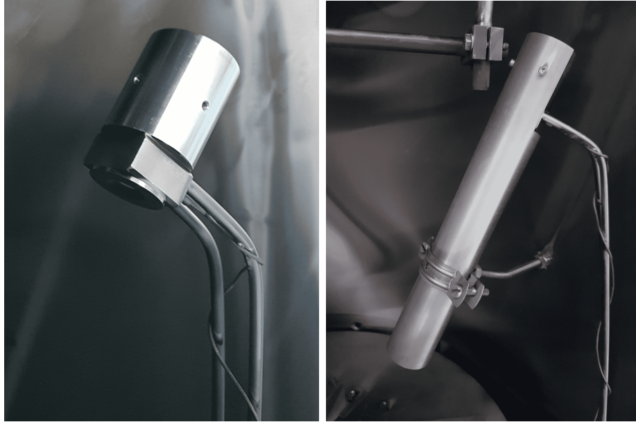
Abbildung 5.1: Auf dem linken Bild ist der Schwingquartzhalter zu sehen. Auf der unteren Seite in der Kreisrunden Mulde befindet sich die Oberfläche des Quarzes. An der Rückseite des Halters wurde ein zur Fixierung des Rohres benötigtes Werkstück befestigt. Die Zuleitungen dienen der Kühlung mittels Wasserdurchfluss. Auf dem rechten Bild sieht man das an den Schwingquartzhalter montierte Kollimatorrohr zur Selektierung der gewünschten Verdampfungskeule. Zur Fixierung der Ausrichtung des Quarzes dient eine Rohrschelle die fest verschraubt werden kann.
