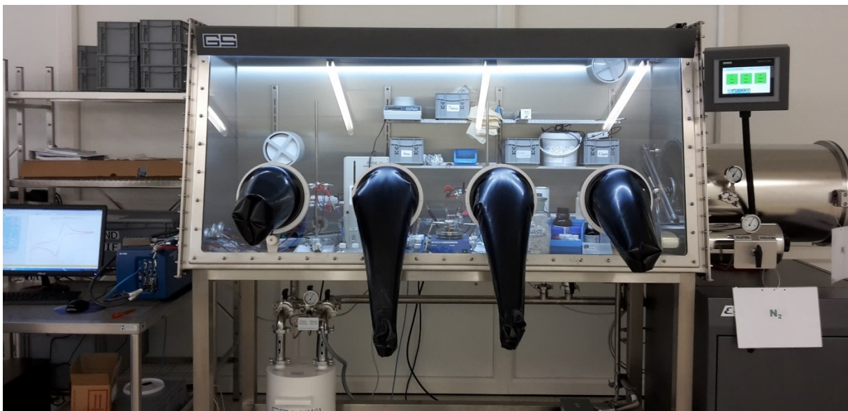
Abbildung 10: Handschuhbox der Firma GS (Modell \epsilon -Line)
