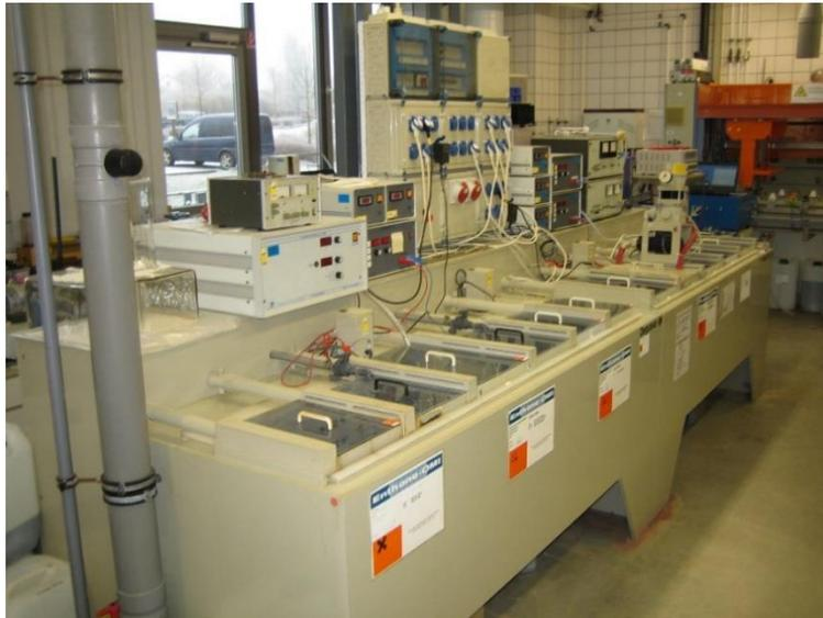
Abbildung 6: Handgalvanikanlage am Fachgebiet Elektrochemie und Galvanotechnik (Badvolumina 45 l).
