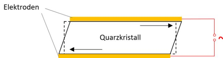
**Abbildung 10: Schematische Darstellung der Dickenscherschwingung eines Quarzes beim Anlegen einer Wechselspannung (Querschnitt).**
