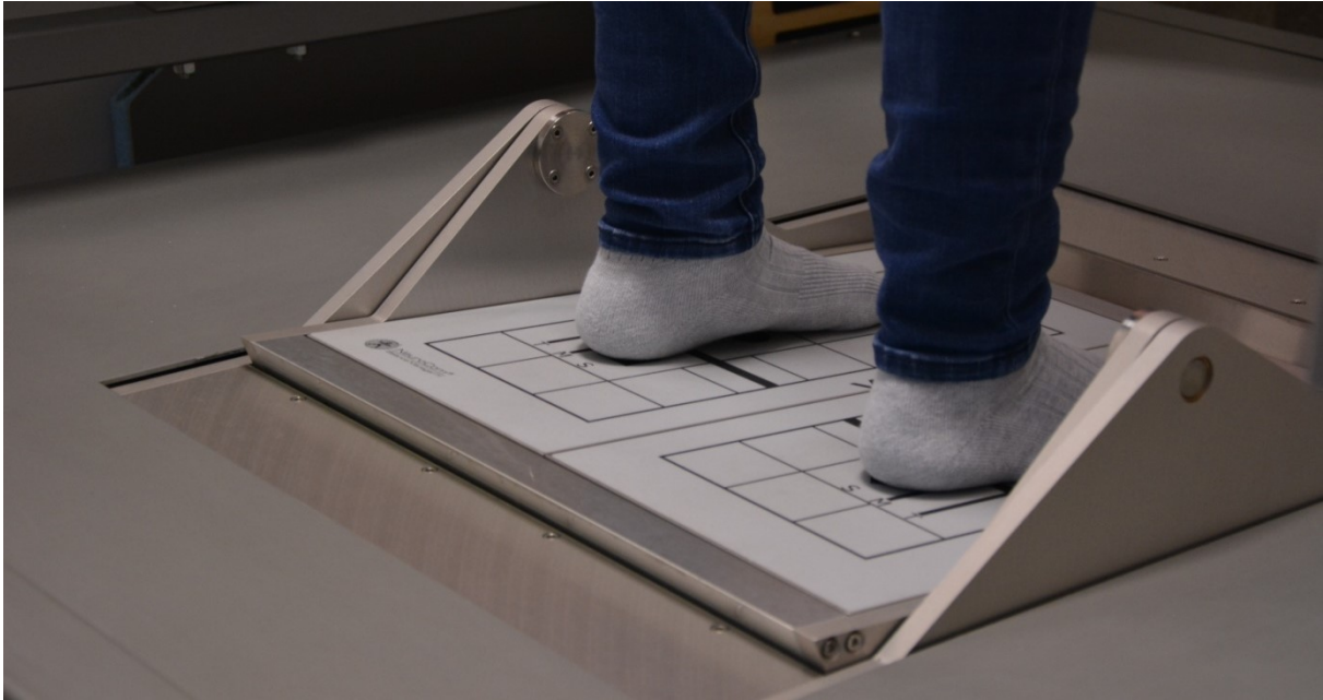
Abbildung 4.1.3: Bewegliche Bodenplatte beim Sensory Organization Test , Abkipfung nach vorn
