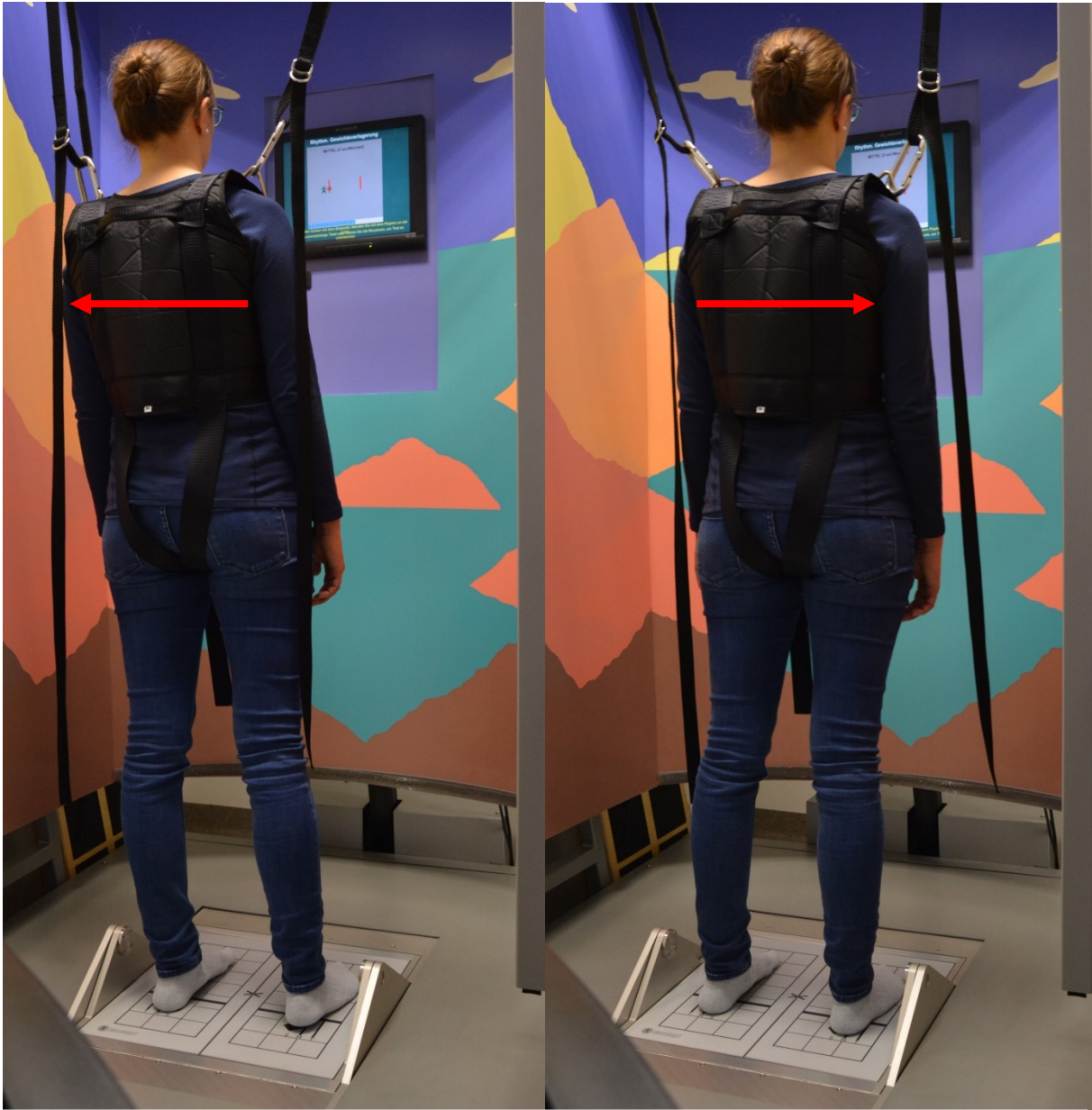
Abbildung 4.1.5: Verlagerung des Körperschwerpunkts nach links und rechts während des Rhythmic Weight Shift Tests
