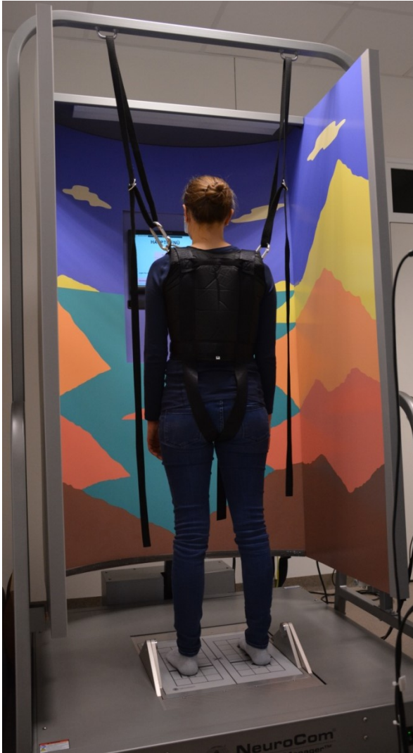
Abbildung 4.1.1: Beispiel eines Probanden im Versuchsaufbau zur Durchführung des Sensory Organization Tests , Motor Control Tests und Rhythmic Weight Shift Tests auf dem NeuroCom Balance Manager
