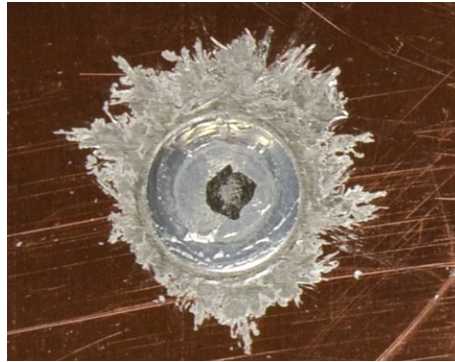
Abbildung 69: Kupferoberfläche nach Auftrennen
