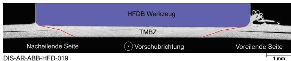
Abbildung 23: HFDB-Verbindung von 0,3 mm EN AW7075/AW2024 [ROO10]
