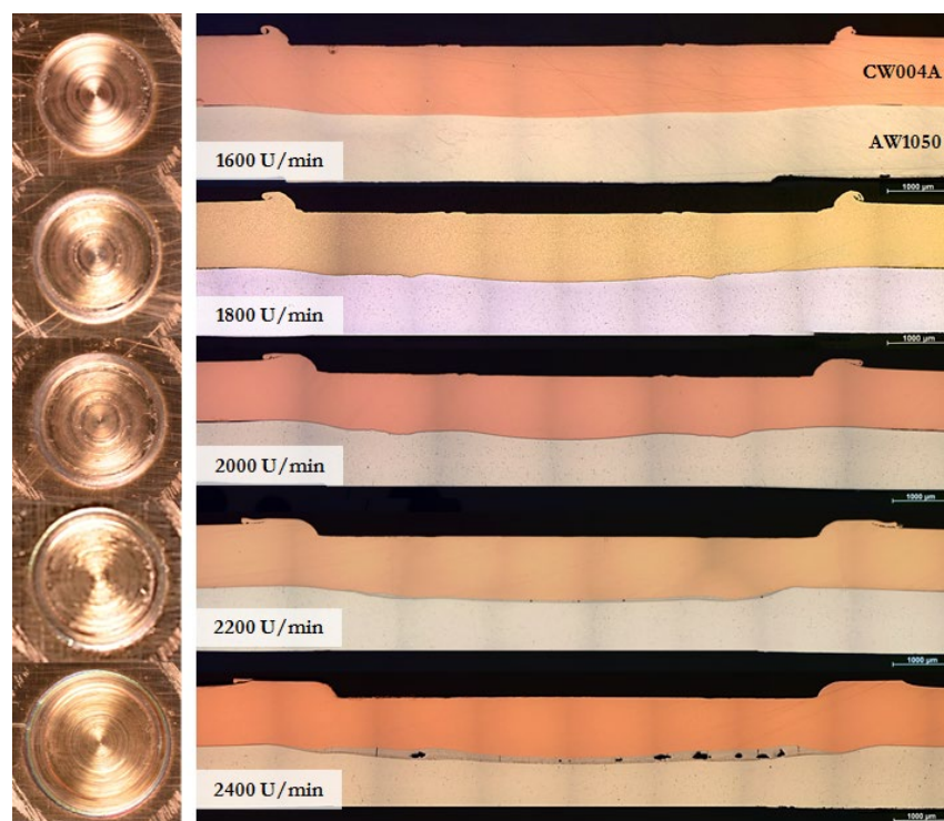
Abbildung 48: Einfluss der Drehzahl auf die Fügezonenausprägung ( v = 25 \text{ mm/min} ; s = 0,3 \text{ mm} ; t = 3 \text{ s} )
