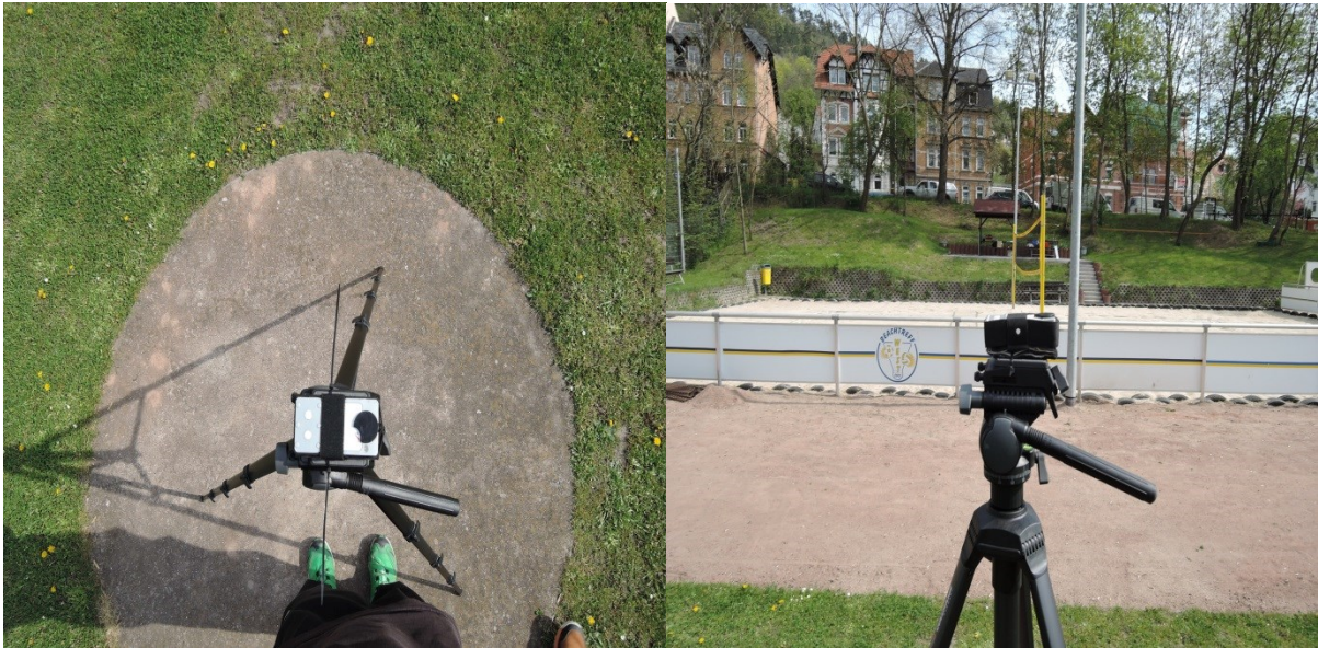
Abb. 5: Dosimeter auf Stativ mit horizontal ausgerichteten Messdioden
