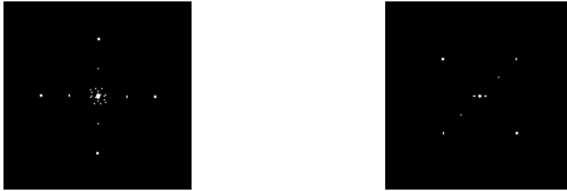
Abbildung 38: Abbildung der diskreten Fouriertransformation des Projektionsbildes der Poren in z -Richtung. Ausschnitt des relevanten Bereichs nach Binarisierung, links: Probe 2, rechts: Probe 4.
