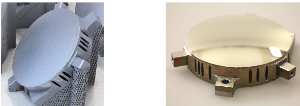
Abbildung 61: Spiegelsubstrat nach dem SLM auf Bauplattform (links) und nach dem finalen Polierprozess (rechts).
