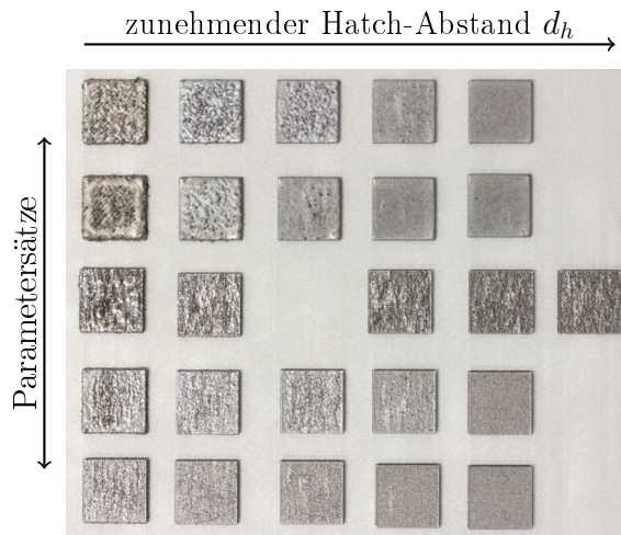
Abbildung 14: Fünf Parametersätze (reihenweise) mit variablem Hatch-Abstand (von links nach rechts zunehmend); Zustand nach Entnahme aus der SLM-Maschine. Die lateralen Abmessungen eines erzeugten Feldes betragen 20 \times 20 \text{ mm}^2 .
