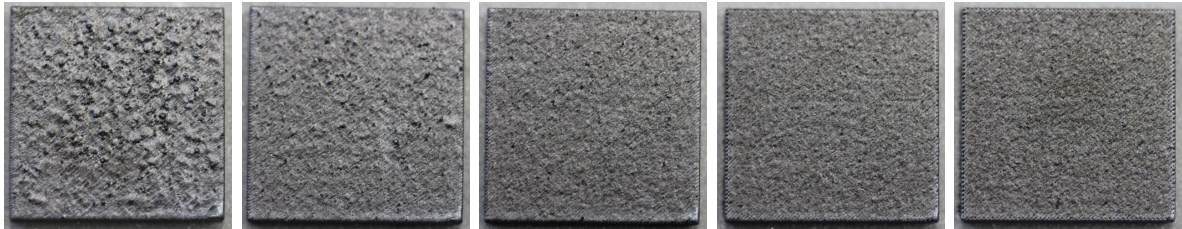
Abbildung 15: Gefertigte Volumenkörper; 200 W, 1,3 m/s; Hatch-Abstand nimmt von links (55 % der Schmelzlinienbreite) nach rechts (95 % der Linienbreite) zu.
