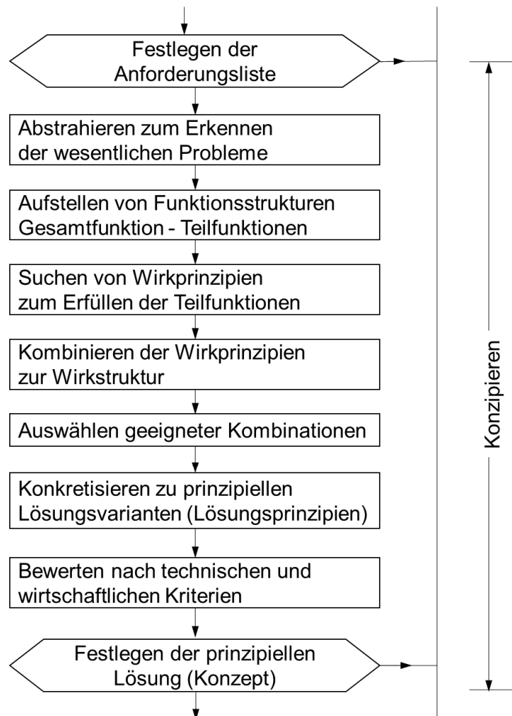
Abbildung 3.1: Arbeitsschritte der Konzeptphase im Konstruktionsprozess, angelehnt an [Pahl et al. 2007]
