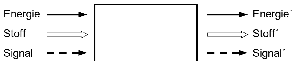
Abbildung 2.2: Beschreibung einer Funktion mit dem Umsatz von Energie-, Stoff-, Signalgrößen anhand eines Black Box-Modells [Pahl et al. 2007]
