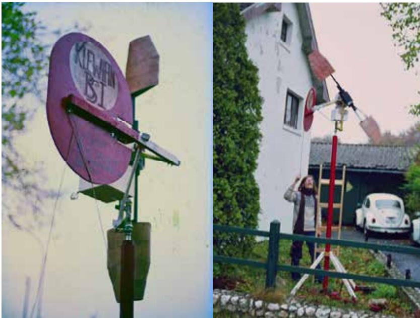
Abb. 3: mobile Kleinwindanlage des Autors, um 1980 (Fotos: Bruno Spessert)
