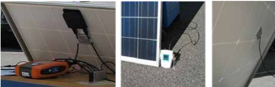
Abb. 1: I-U-Kennliniengerät (links), Einstrahlungssensor (Mitte), Temperatursensor (rechts)
