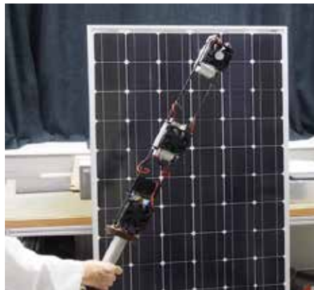
Abb. 4: UV-F-Strahler 150 W (Eigenbau OFI)
