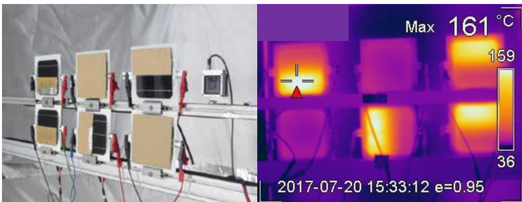
Abbildung 1: Aufbau des Hot-Spot-Tests für 1-Zell-Module mit virtuellem Modul (links) und Infrarot-Aufnahme während der Hot-Spot-Prüfung (rechts)
