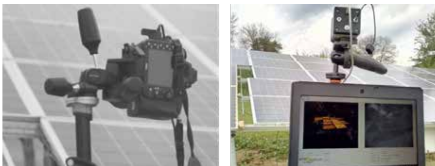
Abb. 3: EL-Kamera, nur Nachtanwendung (links), Tag- und Nachtanwendung (rechts)
