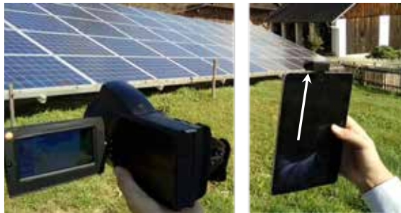
Abb. 2: TG-Kamera tragbar (links), TG-Minikamera für Handy/Tablet (rechts)
