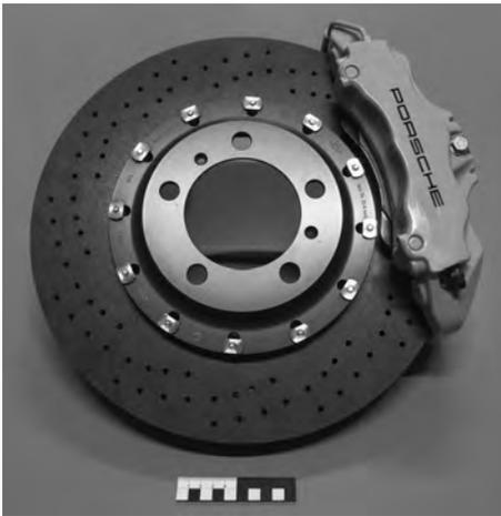
**Abb. 0-2.** Keramische Bremsscheibe aus  $C_f/SiC$ . – Der Bremsscheibenring hat einen Durchmesser von 410 mm und eine Dicke von 38 mm.
