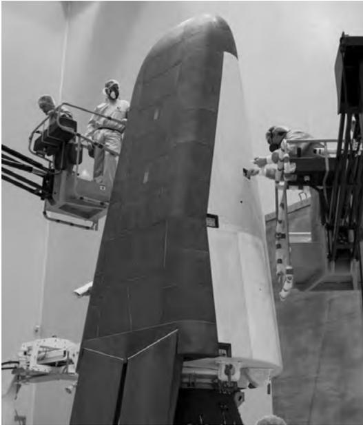
**Abb. 0-1.** IXV Recovery mit Steuerklappen aus  $C_f/SiC$  und ablasivem Hitzeschild aus  $C_f/C-SiC$  [5]. – Copyright ESA–M. Pedoussaut, 2015.
