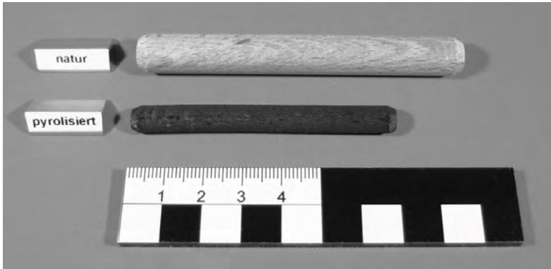
**Abb. 1-3.** Buchenholzdochte zur Flüssigphasensilicierung. – Handelsübliche Buchenholzdübel vor der Pyrolyse, mit ‚natur‘ bezeichnet, und nach der Pyrolyse mit ‚pyroliert‘ bezeichnet.
