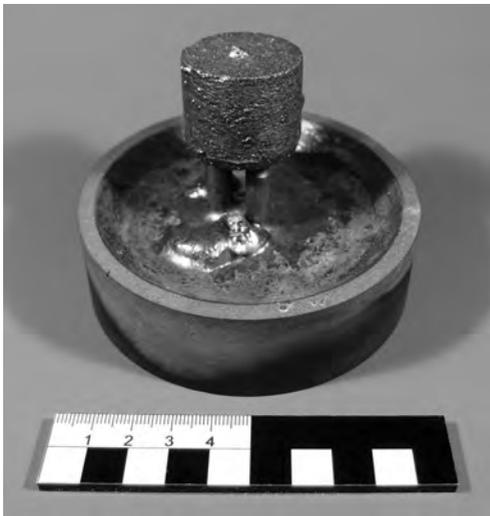
(b)  $C_f/SiC$ -Probe nach der Infiltration.
