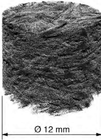
**Abb. B-3.** Computertomografische Aufnahme des Porensystems einer C<sub>f</sub>/C-Probe. – Die Abbildung zeigt in Grau das Porensystem als Negativ der Probe. Mit einer Porositätsanalyse wurde die Porenoberfläche und somit die reaktive Oberfläche zu  $56,3 \cdot 10^3 \text{ m}^2/\text{m}^3$  bestimmt. Zur Auswertung der CT-Daten wurde die Analysesoftware VGStudio MAX 3.0 mit dem Porositätsanalyse-Modul verwendet.
