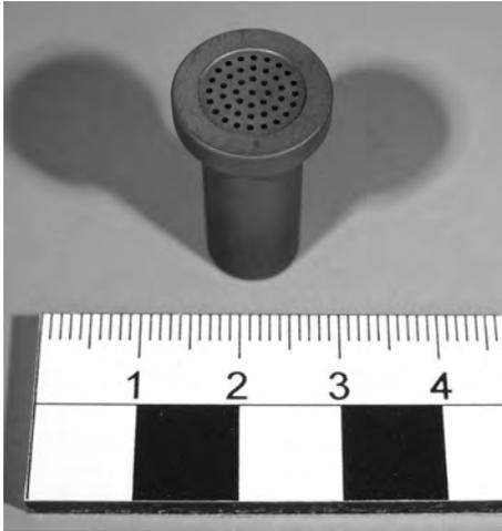
**Abb. 6-1.** Grafitdocht mit Kapillarbohrungen. – Die 43 Durchgangsbohrungen mit  $\varnothing 0,6$  mm fördern das Silicium im Überschuss zur Probe. Zur flächigen Benetzung wurde die Kontaktfläche auf einen Durchmesser von 10 mm und eine Tiefe von 0,2 mm abgesetzt. Der Dochtdurchmesser im unteren Bereich beträgt 10 mm und im oberen Bereich 15 mm; bei einer Gesamtlänge des Dochtes von 27 mm.
