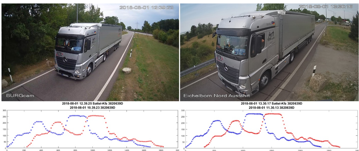
Abbildung 12: Standardfall: Sattel-Lkw (OBU-ID 3820639D) an Ein- und Ausfahrt erfasst sowie Daten der Vergleichssysteme (Kamerabild und Verstimmungskurve mit automatischer Klassifikation).
