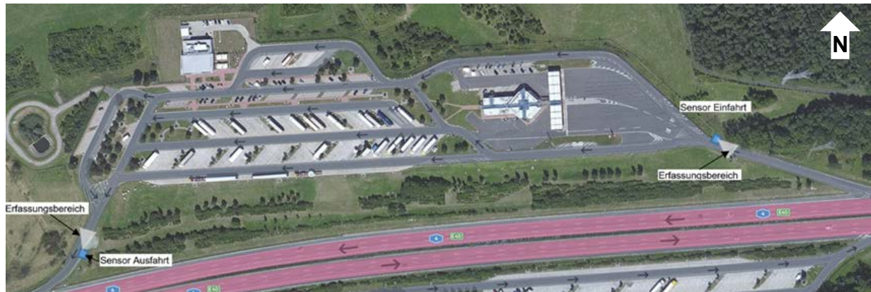
Abbildung 4: Luftbild T&R-Anlage Eichelborn Nord mit Markierung der Positionen der Mess- und Zähleinrichtung (Quelle des Luftbildes: Google LLC).
