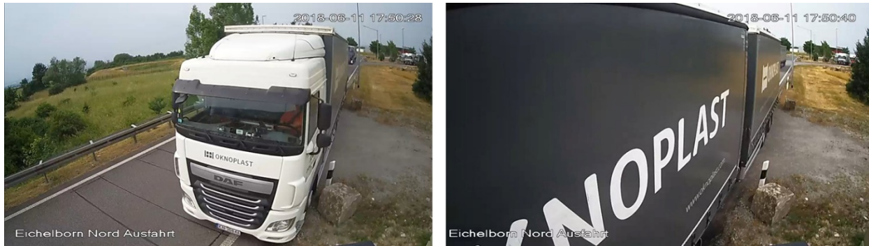
Abbildung 24: Blockieren des OBU-Transceivers (Ausfahrt) und beider Vergleichssysteme, wodurch kein Kontaktaufbau zu weiteren Lkw (OBU-Antennen) mehr möglich ist.
