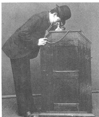
Kinetoskop mit eingebautem Phonographen
