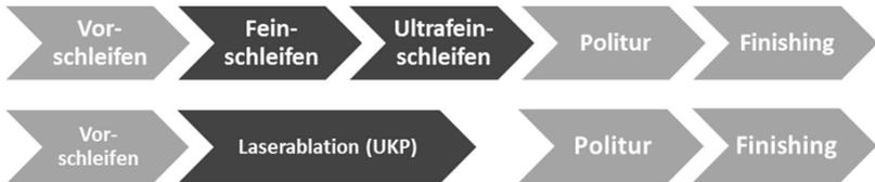
*Abbildung 13: Verkürzung der Prozesskette zur Herstellung präzisionsoptischer Komponenten durch die Substitution der Fein- und Ultrafeinbearbeitung durch die Laserablation mittels Ultrakurzpuls-Laser*
