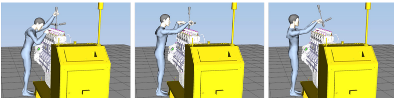
Abbildung 85: Einstellen des Ventilspiels bei 0^\circ (Otto, 2011)
