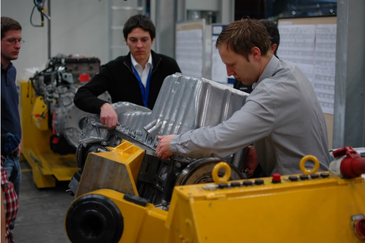
Abbildung 65: Montage der Ölwanne
