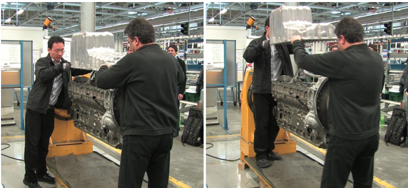
Abbildung 66: Montage der Ölwanne mit unterschiedlichen Positionen des Motors (Otto, 2011)
