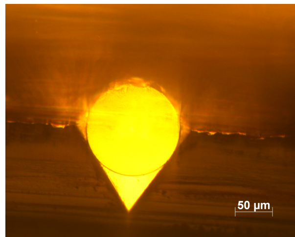
Abbildung 6.14: Mikroskopaufnahme einer Faser in Kontakt mit den beiden Seitenwänden (Quelle: [15])
