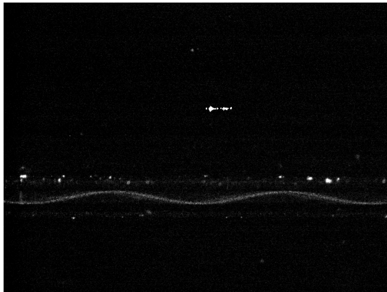
Abbildung 9.11: Mikroskopaufnahme des Ausbreitungspfad des Lichts aus einer 635 nm Single-Modedefaser durch eine GI62.5-Faser.
