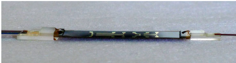
Abbildung 4.1: Fasergekoppeltes Wellenleitermodul mit Stabilisierungsblöcken, in Glasblock gefasstes Glasfaserflachbandkabel (rechts & links).
