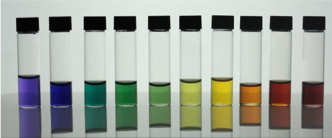
*Abbildung 24: Dispersionen von Silber-Nanopartikeln in Wasser. Die unterschiedlichen Farben wurden durch die Bestrahlung der Dispersionen mit sichtbarem Licht unterschiedlicher Wellenlängen erzeugt.*
