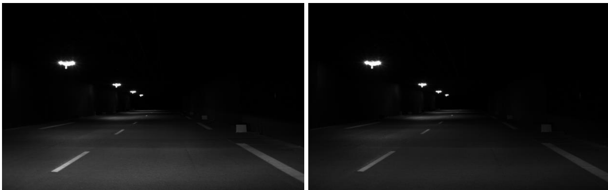
Abbildung 2: Graustufen-Darstellung von Leuchtdichte aufnahmen zum ersten Szenario mit Abblendlicht und angeschalteten LED-Laternen. Links: Referenzlichtverteilung. Rechts: auf 51% gedimmte Lichtverteilung.
