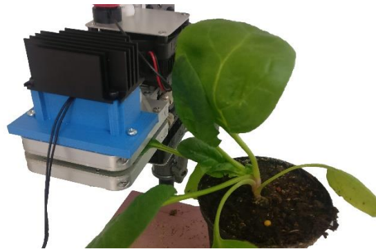
Abbildung 4 Gaswechsellmessung an dem Blatt einer Spinatpflanze
