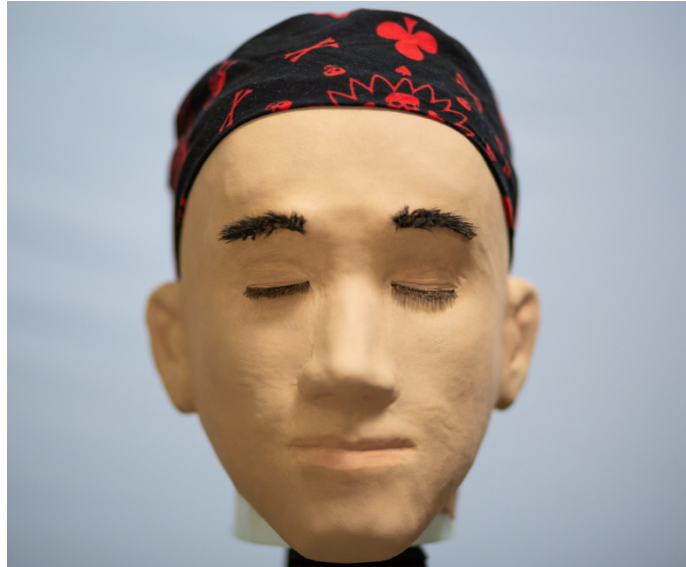
Abbildung 10: Fertiger Messkörper mit Make-up und Behaarung
