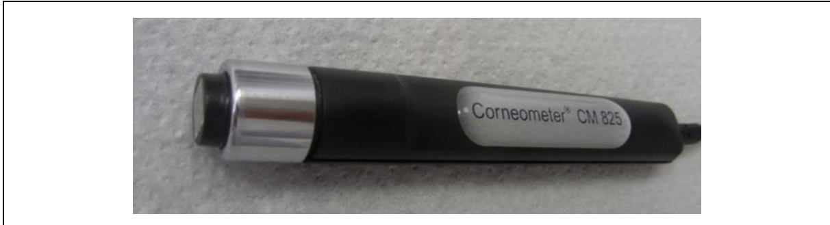
Abb. 3: Corneometer® CM 825. Der Sondenkopf (links im Bild, ohne Schutzkappe dargestellt) wird bei der Messung plan auf die Haut gedrückt. Copyright: Klinik für Hautkrankheiten, Jena.
