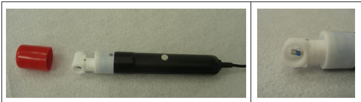
Abb. 4: Tewameter® TM 300. Links: Messeinheit mit Schutzkappe. Rechts: Sondenkopf. Copyright: Klinik für Hautkrankheiten, Jena.
