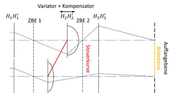
Abb. 2 Kollineares Startsystem eines möglichen hybriden Fotozoomobjektivs
