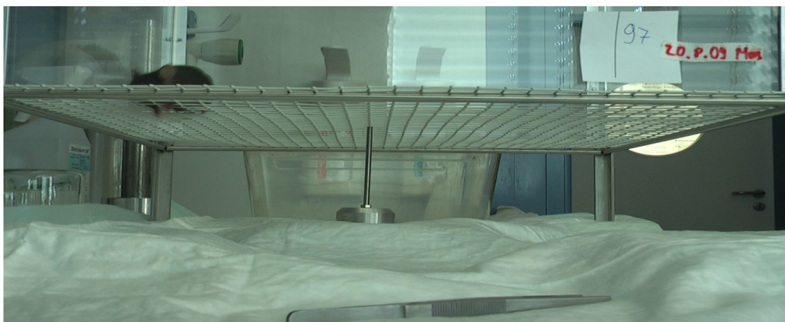
Abbildung 4: Versuchsaufbau des Gridwalk-Tests
