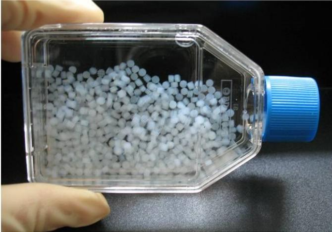
**Abb. 8: Fertiggestellte BNC-Zylinder nach Aufreinigung (ca. 500 Stück).**
