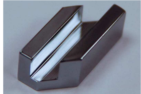
Abbildung 4.7: Channel-Cut-Kristall aus Silizium. Im Graben wird der Röntgenstrahl viermal an den Seitenwänden reflektiert [12].
