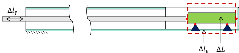
Abb. 13: Wirksamer Bereich (gestrichelt) der Probenhalterkorrektur
