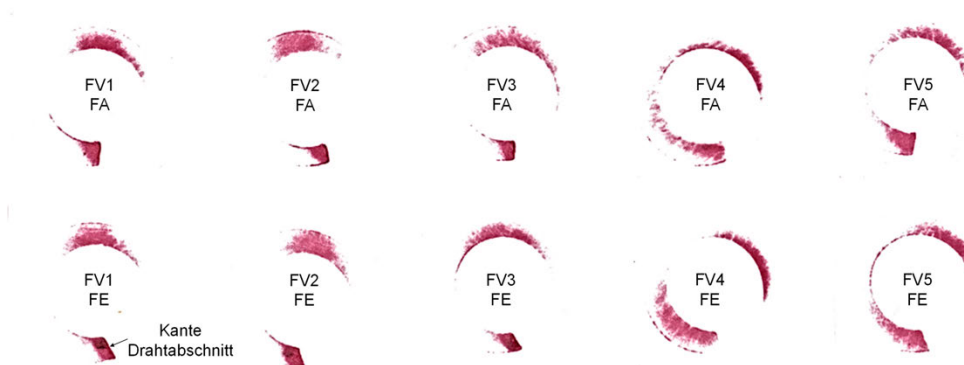
Abbildung 7.19: Kontaktdruckverteilung an der Federaufstandsfläche bei einer Federkraft von 0 N bis 1000 N, oben Federanfang (FA), unten Federende (FE)
