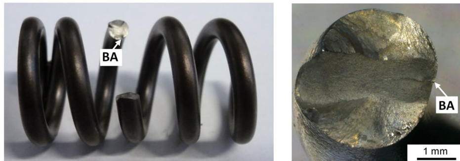
Abbildung 2.8: Federbruch im federnden Windekörper mit einem Bruchausgang an der Federinnenseite
