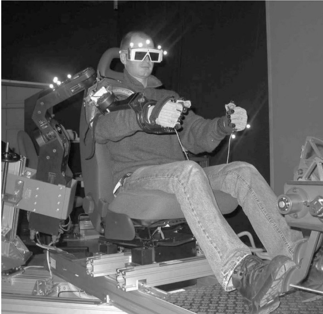
Abbildung 29: Beispieldarstellung einer Sitzkiste mit Force-Feedback-Aufbau.
