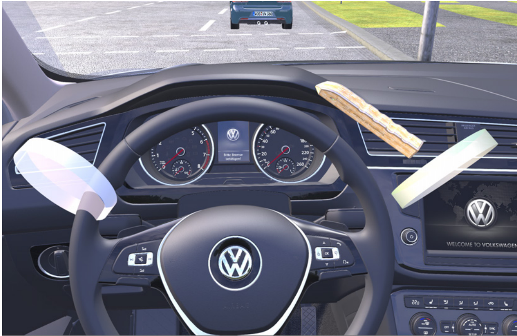
Abbildung 43: Darstellung der virtuellen Manschetten als Repräsentation der VibroTac Armbänder und des Pointers. Die Abbildung zeigt eine Versuchsperson mit den Händen am Lenkrad. Quelle: Eigene Darstellung.
