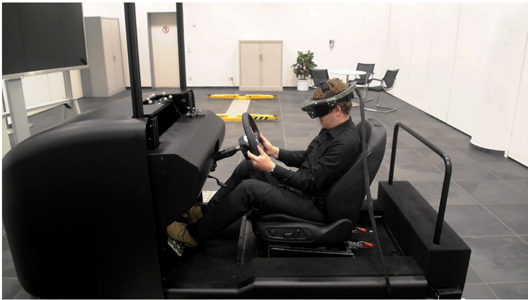
Abbildung 13: Beispieldarstellung einer Head-Mounted-Display-basierten Sitzkiste. Quelle: Eigene Darstellung.
