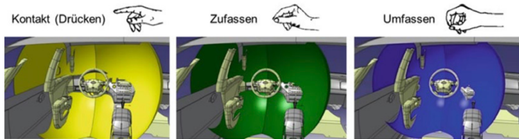
Abbildung 23: Beispiel für unterschiedliche Reichweiten einer sitzenden Person nach Art des Griffs und der daraus resultierenden Greifräume im Fahrzeugcockpit. Quelle: Bubb et al. (2015, S. 419).
