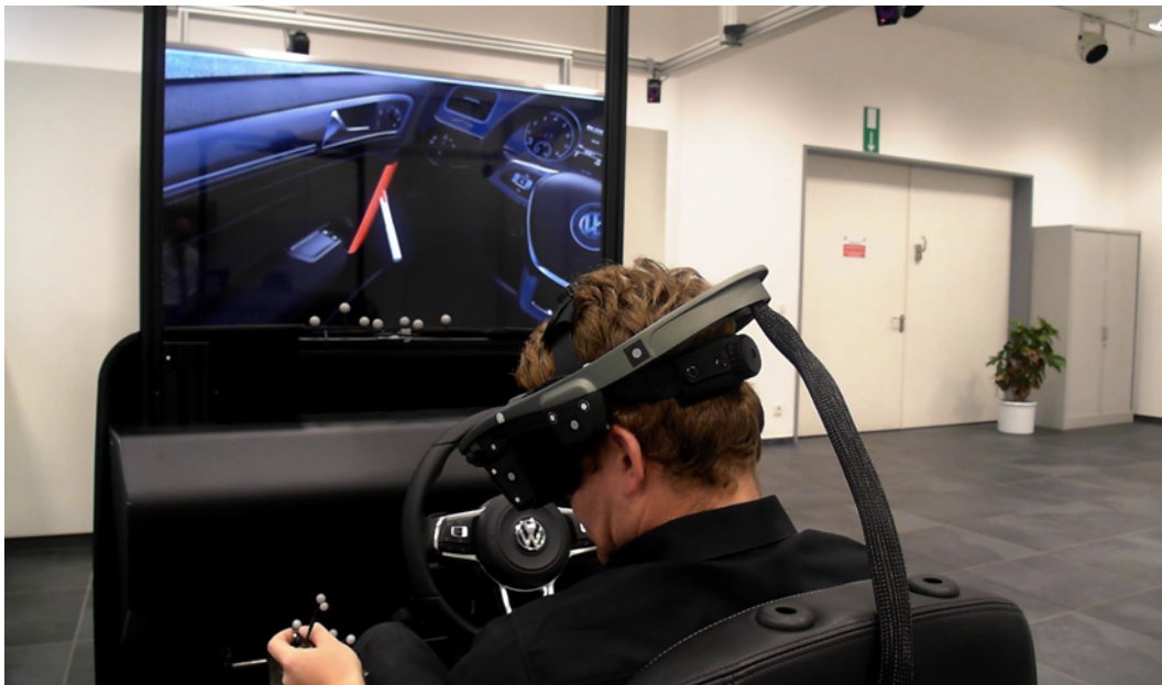
Abbildung 19: Beispiel für die Durchführung einer Erreichbarkeitsbeurteilung in der virtuellen Sitzkiste. Quelle: Eigene Darstellung.
