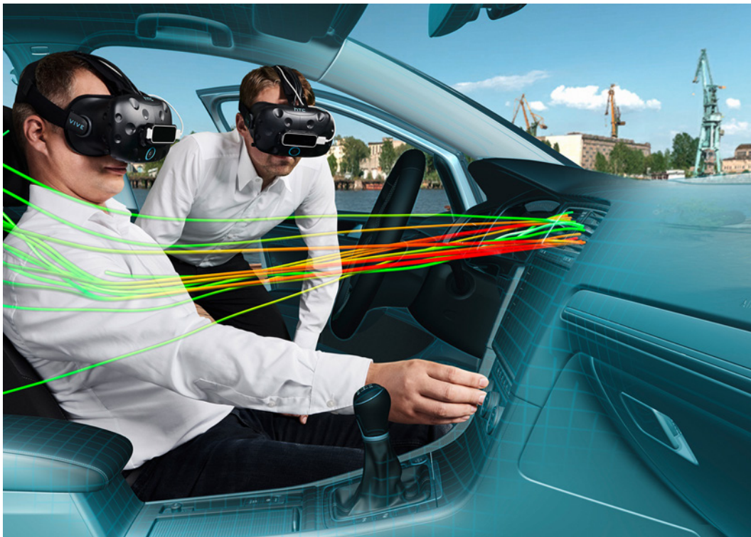
Abbildung 22: Prinzipdarstellung der Visualisierung simulierter Luftströme in der immersiven virtuellen Umgebung. Quelle: Volkswagen AG (2017).
