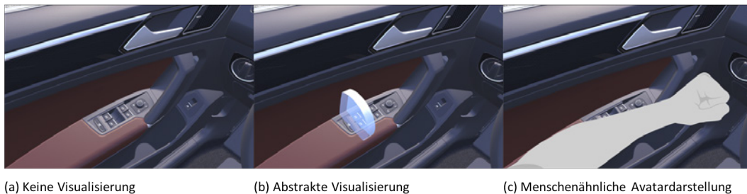
Abbildung 50: Vor- und Nachteile der visuellen Nachkontrolle bei der Beurteilung der Armauflage ohne eine Visualisierung der vibrotaktilen Armbänder (a), mit einer abstrakten Visualisierung (b) und mit einem menschenähnlichen Avatar (c). Quelle: Eigene Darstellung.
