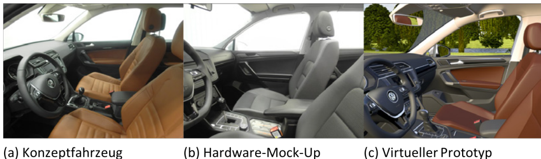
Abbildung 26: Stimulusmaterial: Darstellung des gleichen Fahrzeuginnenraums mithilfe eines Konzeptfahrzeugs (a), eines Hardware-Mock-Ups (b) und in der virtuellen Sitzkiste (c). Quelle: Eigene Darstellung.
