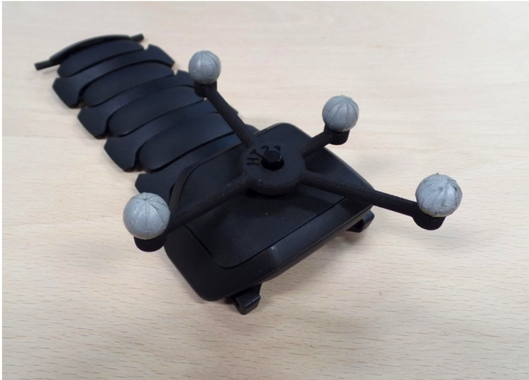
Abbildung 36: VibroTac-Armband mit einem am Deckel befestigten ART-TRACK3-Tracking-Target. Quelle: Eigene Darstellung.
