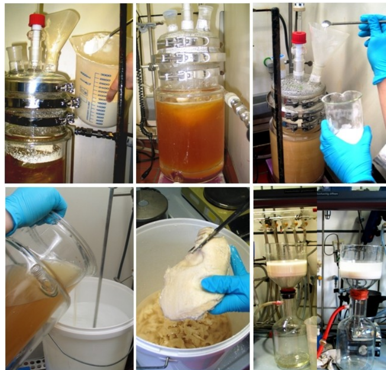
Abb. 3.8: Reduktion von Tapiokastärke ST07 im 900 g-Maßstab; oben links: Suspendieren der Stärke in Wasser, oben mitte: wässrige Stärkelösung, oben rechts: Zugabe von Natriumborhydrid (NaBH 4 ), unten links: Fällung des Produkt in Ethanol, unten Mitte: Zerkleinerung des Rohproduktes, unten rechts: Filtration des Produktes vom Waschmedium.
