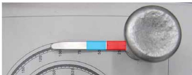
**Abbildung 44: Fotografischer Ausschnitt eines Probenabgusses.** Der rote Bereich wurde für Metallographie und der blaue für Härtemessung genutzt. Angaben in Millimeter.
