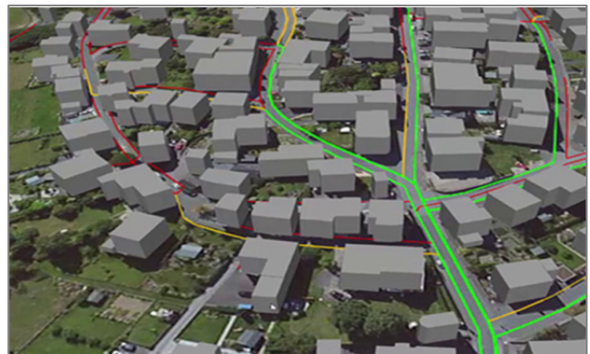
Abb. 4. Virtual Reality-Visualisierung mit Luftbild, Gebäuden und geplantem Glasfasernetz mit farblicher Darstellung der Installationskosten (rot, gelb, grün). Quelle: Wiggenbrock (2016).
