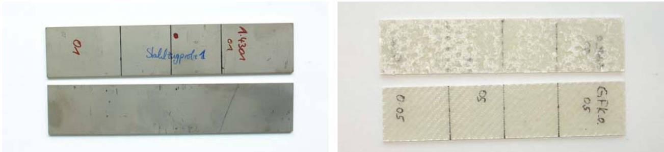
Abb. C.1: Streifenproben Edelstahl 1.4301 (links) und GFK 0°-Ausrichtung (rechts)
