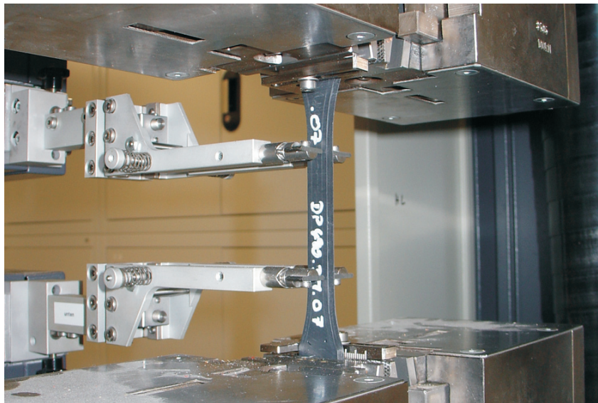
Abb. 4.38: Zugversuch 3M DP 490 mit 4%/min
