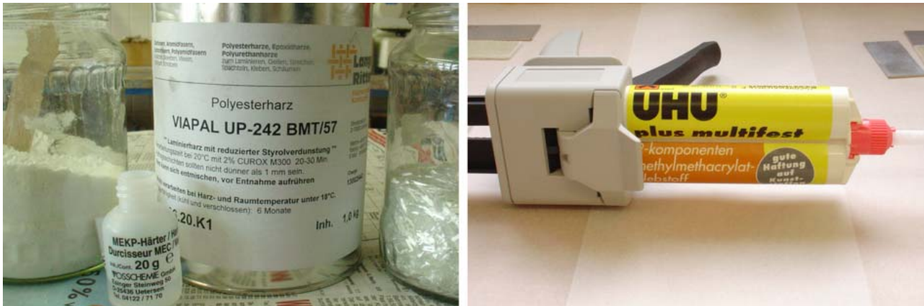
Abb. 4.14: Gebinde für die Klebstoffe - links: gefülltes Laminierharz VIAPAL UP 242 BMT/57, rechts: UHU plus multifest
