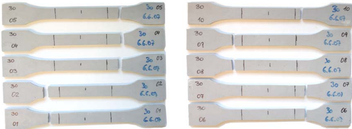
Abb. C.7: Bruchbilder der SI30-Schulterstäbe
