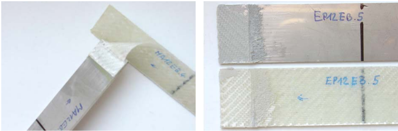
Abb. 4.30: typische Bruchbilder links: MA-Verklebungen, rechts: SI31-Verklebungen
