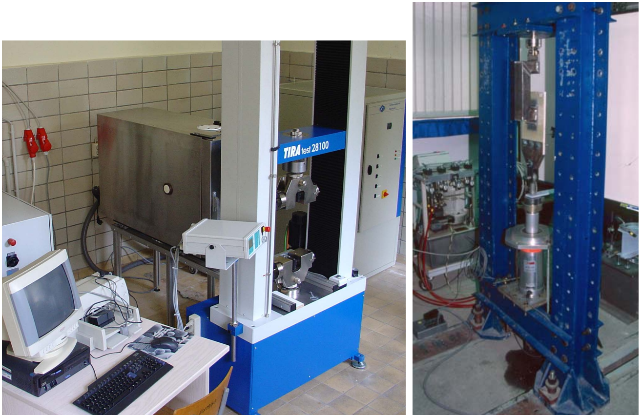
Abb. 4.10: Prüfstände der bauteilähnlichen Proben, links: Versuchsstand TIRATEST 28100, rechts: individueller Prüfrahm
