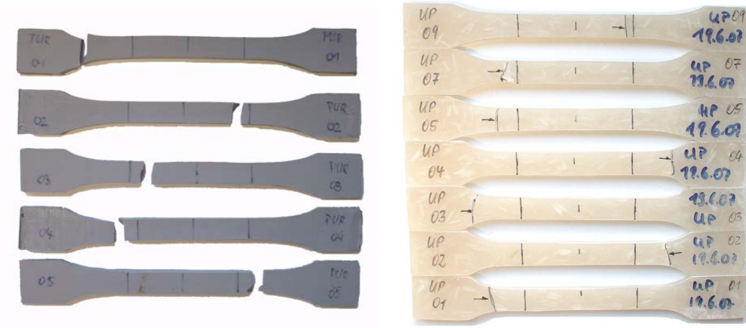
Abb. C.5: Bruchbilder PUR (links) und gefülltes UP-Harz (rechts)
