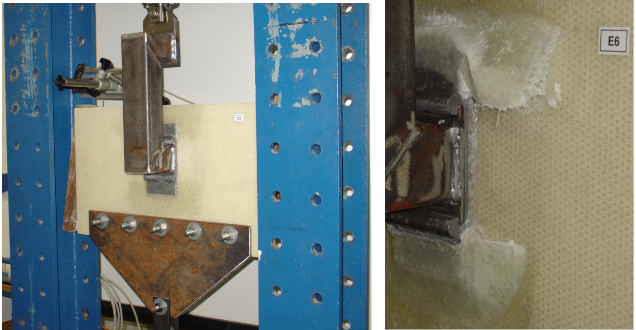
Abb. A.20: li: Versuchsanordnung Serie E mit horizontalem Wegaufnehmer, re: Bruchdetail E6
