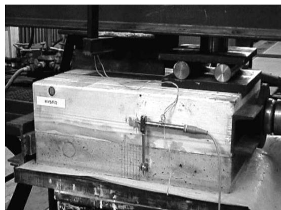
Abbildung A.2: Aufnahme des Slip-Block-Tests
