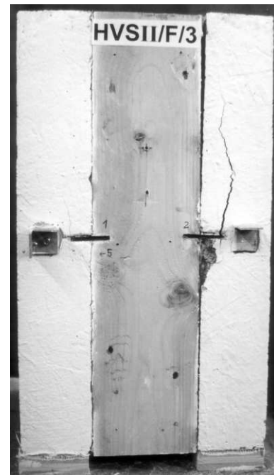
Abbildung 2.8: Ungleichmäßige Ausnutzung der VM infolge Schrägstellung
