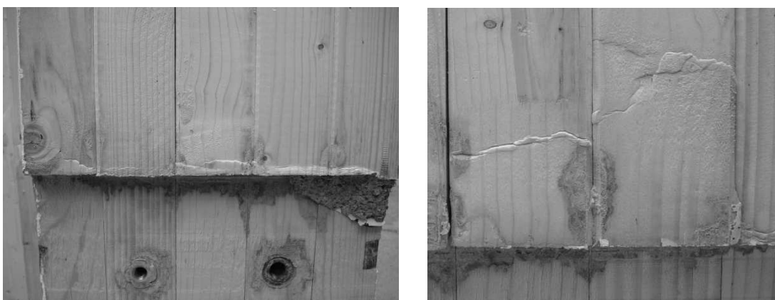
Abbildung A.48: Holzdruckversagen an den spitzen Kanten der Kerveneinschnitte: (l) HBV/80-1 (r) HBV/80-3 an der 3. und 4. Lamelle
