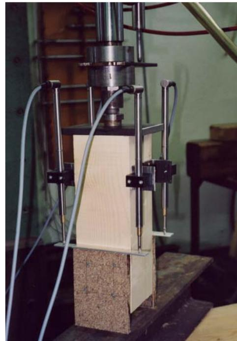
Versuchskörper Belastung  $\parallel$  zur Faser
