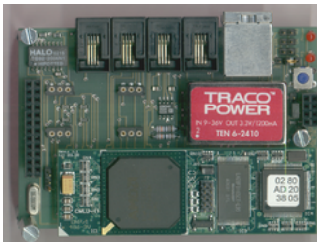
Abbildung 2: Ein am Fraunhofer-ISE entwickeltes embedded system mit x86-kompatiblen Prozessor, 8MB RAM und Netzwerkanschluss
