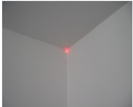
Abb. 7.14.: Vom Motortachy angefahrne und mittels Laser gekennzeichnete Punktposition aus dem Geometriemodell
