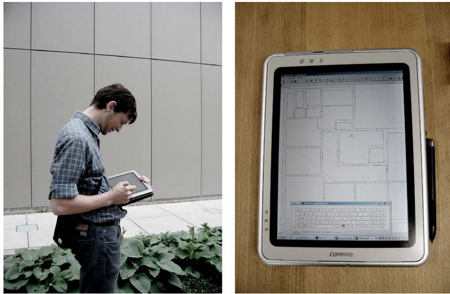
Abb. 4.1.: Tablet-PC mit Experimentalplattform bei einem Handaufmaß (InfAR 2003)
