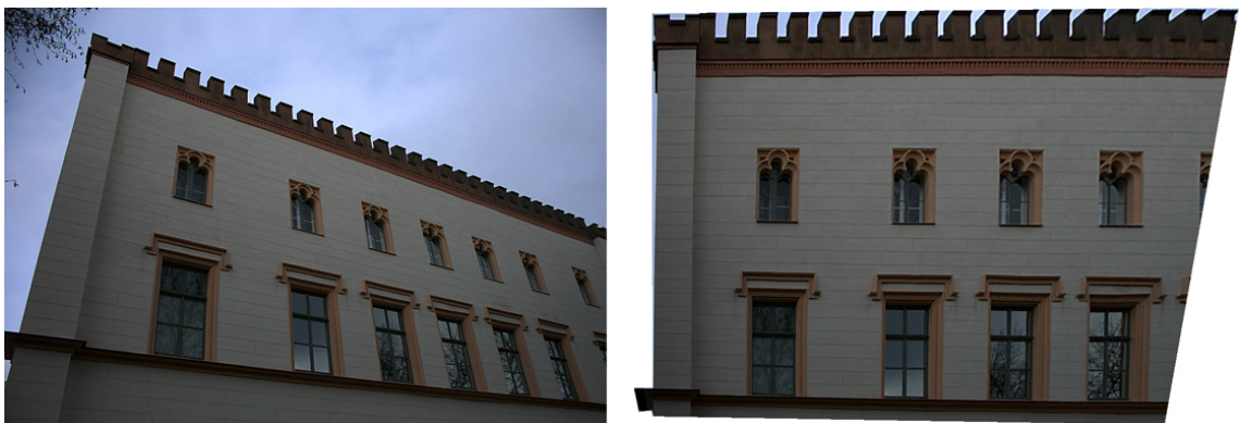
Abb. 3.8.: Aufnahme einer Fassade des Lehrstuhlgebäudes und eine Entzerrung (InfAR 2003)
