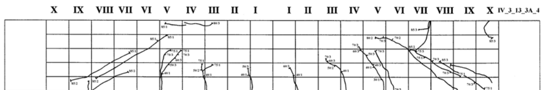
Abb. B3.7.4 Rissbild des Versuchsbalkens VI_3_13_A3_4
