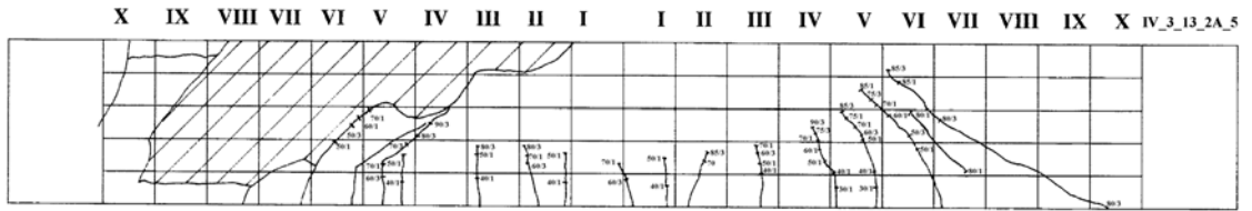
Abb. B3.6.1 Rissbild des Versuchsbalkens VI_3_13_2A_5
