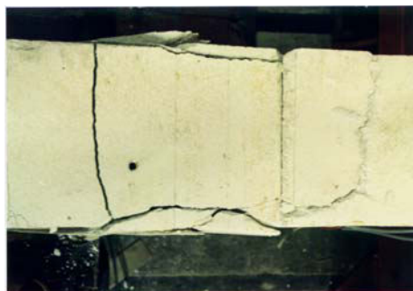
Abb. 6.1.4.4 Draufsicht auf Versuchsbalken VI/3/13/AD_1.5_1 mit Schubschlankheit von a/d=1,5
