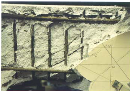
Abb. 6.1.3.4 Detail der Versagenszone des Versuchsbalkens VI/3/13/ds_12_1
