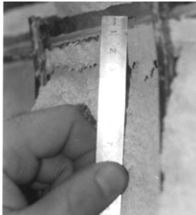
Abb. 4.2.4.6 Ausdehnung der verdichteten Zone unterhalb des Verankerungsstabes
