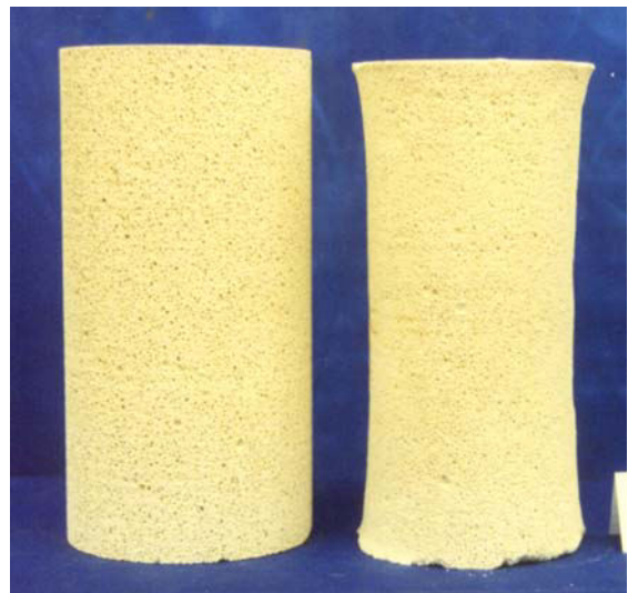
c Bruchbild der Versuchsserie 3 (rechts); links: intakte Probe
