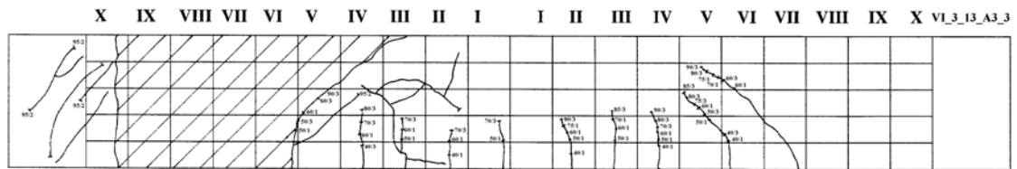
Abb. B3.7.3 Rissbild des Versuchsbalkens VI_3_13_A3_3
