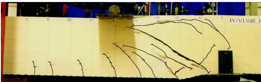
Abb. 6.1.3.3 Bruchbild des Versuchsbalkens VI/3/13/ds_8_1 mit einem Verankerungstabdurchmesser 8mm
