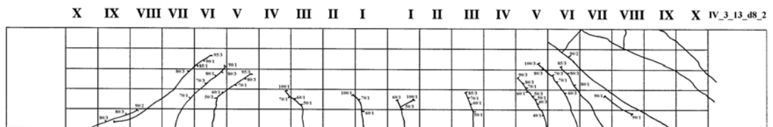
Abb. B4.10.2 Rissbild des Versuchsbalkens VI_3_13_ds_8_1
