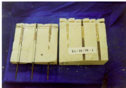
Abb. 4.2.4.9 d_{sA} 10mm; e=50 mm
