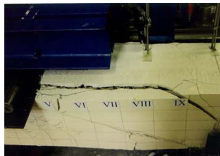
Abb. 6.1.4.5 Ansicht des Versuchsbalkens VI/3/13/AD_3_3 mit Schubschlankheit von a/d=3,0
