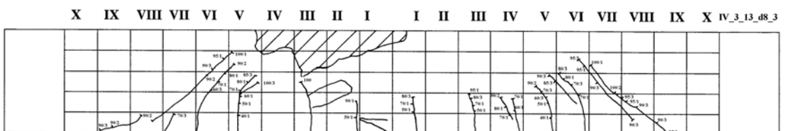
Abb. B3.10.3 Rissbild des Versuchsbalkens VI_3_13_ds_8_1
