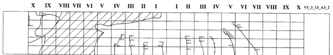
Abb. B3.7.2 Rissbild des Versuchsbalkens VI_3_13_A3_2
