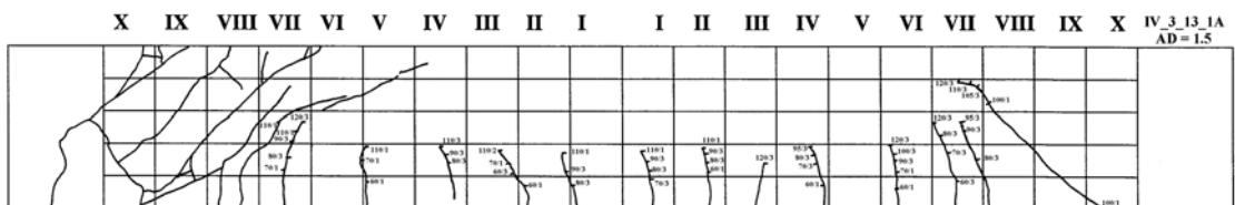
Abb. B3.2.1 Rissbild des Versuchsbalkens VI_3_13_a/d_1.5_1
