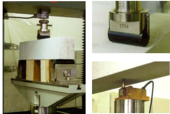
Abb. 3.2.2.6 a) Probekörper während der Versuche (links) b) Krafteinleitungsrolle in Balkenmitte (rechts oben) c) Angriffspunkt des induktiven Wegaufnehmers (rechts unten)
