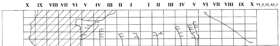
Abb. B3.7.1 Rissbild des Versuchsbalkens VI_3_13_A3_1
