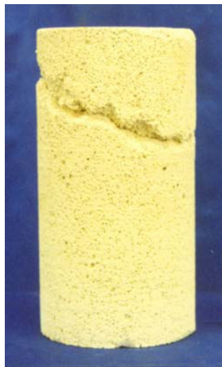
b Bruchbild der Versuchsserie 2
