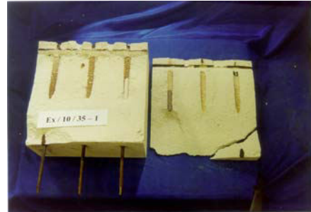
Abb. 4.2.4.8 d_{sA} 10mm; e=35 mm
