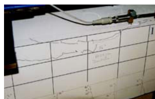
Abb. 6.1.1.9 Detail: Fortschreitende Zerstörung der Balkendruckzone (VI/3/13/4A_5 mit einem Bügelabstand s_w=20\text{cm} )
