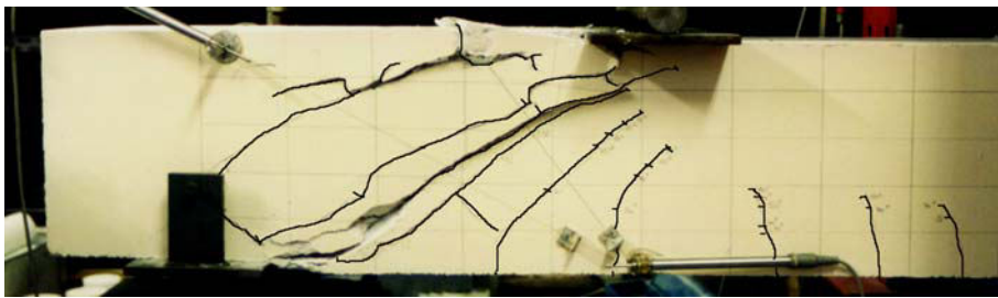
Abb. 6.1.3.1 Bruchbild des Versuchsbalkens VI/3/13/ds_12_1 mit einem Verankerungstabdurchmesser 12mm
